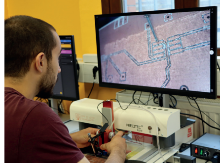
Positionnement de composants montés en surface sur circuits imprimé (Fablab L'ATELIER).
