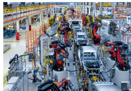
Ligne de production : assemblage de voitures avec soudage automatisé (Crédit photo : Freepik.com)
