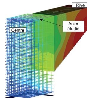
Détermination des températures d'échauffement pour un chevêtre de pile avec CESAR LCPC © Diadès
